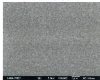
酸化チタン結晶で覆われた緻密な塗膜
