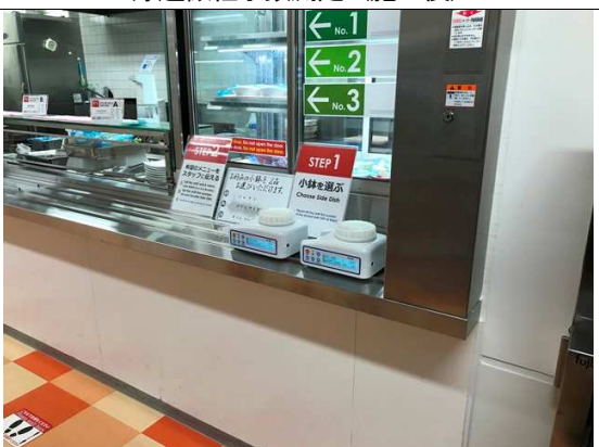
空中浮遊微生物測定 (施工後)
