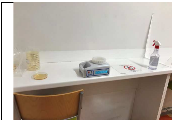
空中浮遊微生物測定 (施工前)
