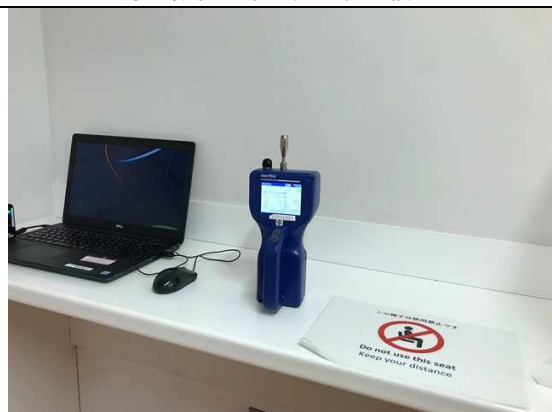
浮遊微粒子数測定 (施工後)
