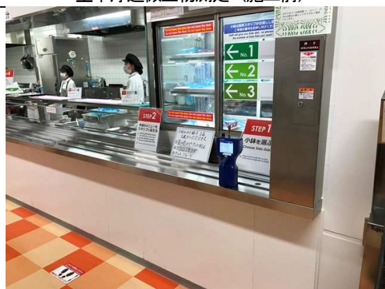
浮遊微粒子数測定 (施工前)
