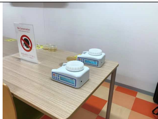
空中浮遊微生物測定 (施工後)
